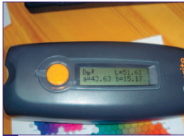
Рис. 6. Дисплей в верхней части спектрофотометра показывает измененные Lab-координаты
